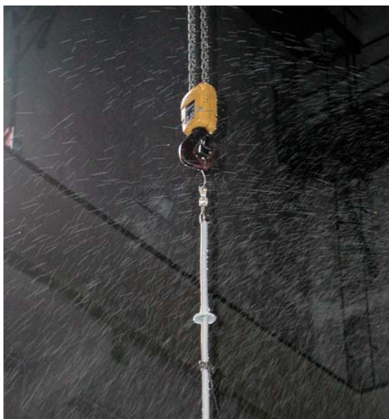
Fig. 5.7.1.3: Prueba de tensión vertical bajo lluvia.
