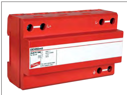
Fig. 9.18.1.1: Descargador combinado tipo 1, DEHNlimit PV, para protección de inversores fotovoltaicos contra sobretensiones, incluso en caso de impacto directo de rayo.
