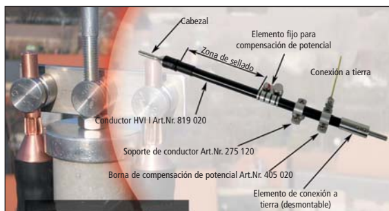
Fig. 5.2.4.1.3: Conductor HVI I y componentes del sistema DEHNconductor.
